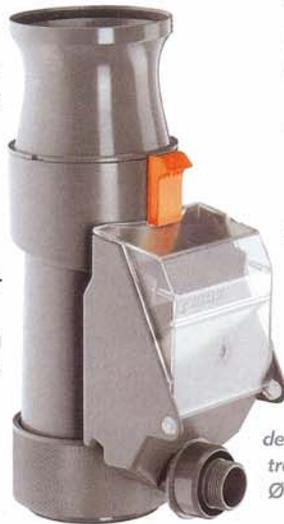
Ce collecteur en PVC dispose d'un système de filtration à deux niveaux avec filtre fin amovible. Commutateur à deux positions : récupération filtrée ou écoulement normal de l'eau. Capot transparent, trop-plein, raccordement Ø 26/34. Gardena
