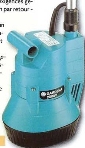
Grâce à son tube de refoulement télescopique et coudé, cette pompe de 300 W est facile à suspendre dans la cuve d'un récupérateur. Une fois immergée, elle peut alors alimenter une lance d'arrosage ou remplir un arrosoir. Turbine à un étage, débit de 2,2 m<sup>3</sup>/h. Gardena
