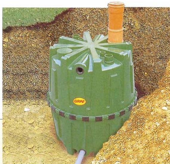
Assemblé à partir de deux demi-cuques réunies par un joint et des clips, ce réservoir d'une capacité de 1,6 m<sup>3</sup> (Ø 109/135 x 160 cm) est conçu pour être enterré. Accessoires disponibles séparément : tuyau de maintien, set de tirage, de jumelage, etc. Hercule de Graf
