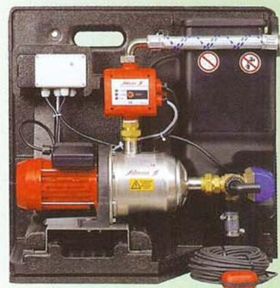
Récupéo est un module pompe surpresseur raccordé à l'arrivée d'eau de pluie, d'une part, et au réseau d'eau de ville, d'autre part. Un filtre d'eau de pluie est mis en place entre la toiture et la cuve. Le dispositif sépare les réseaux d'eau de pluie et d'eau de ville et assure le basculement automatique sur le réseau d'eau de ville lorsque la cuve d'eau de pluie est vide. Récupéo, c'est également une gamme complète d'accessoires et de cuves. Salmson
